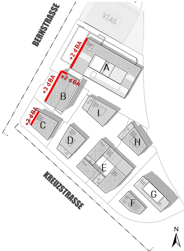
Abbildung 3: Lärmbeurteilung Strassenlärm. Rot: Fassaden mit IGW-Überschreitungen für Wohnnutzung und Überschreitung in dBA in der massgebenden Nachtperiode. Die abgebildete Nutzungsverteilung Wohnen - Büro ist exemplarisch zu verstehen.
