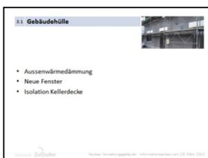
Wichtigster Punkt des Konzeptes ist die Sanierung sämtlicher Fassadenteile. Die Fassaden werden mit einer Aussenwärmendämmung versehen und die Fenster ersetzt. Zudem wird auch die Kellerdecke des unbeheizten Teils neu isoliert.
