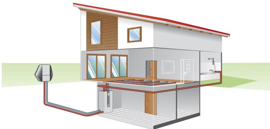
Abbildung 17: Prinzip einer Luftwärmepumpe.
