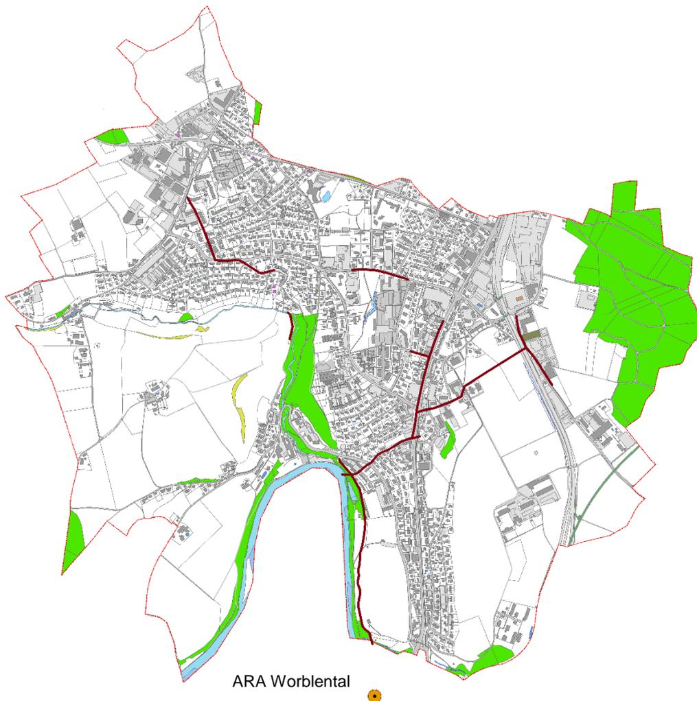
Abbildung 13: Abwasserkanäle mit Durchmesser von mindestens einem Meter (braune Linien).
